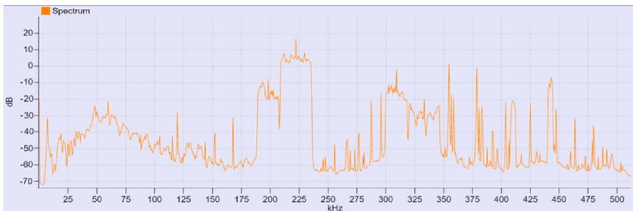
Рис. 1. Пример загруженного спектра частот высокочастотной связи
