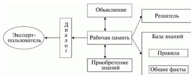
Рис. 1. Типовая структура экспертной системы
