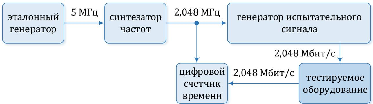
Рис. 1. Пример схемы измерений выходного джиттера
