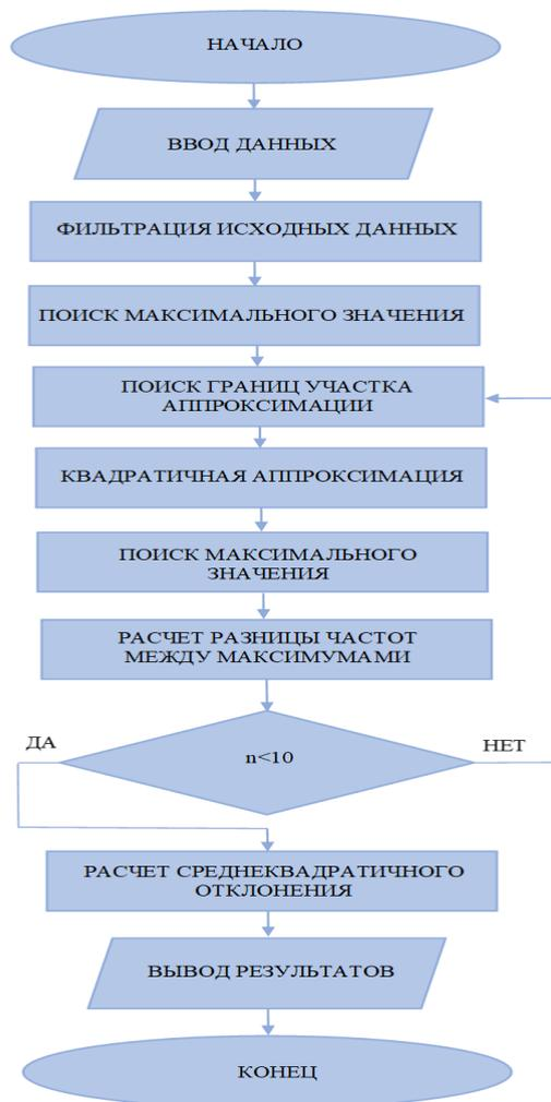
Рис.2. Блок-схема алгоритма поиска позиции максимума частотной линии вынужденного рассеяния Бриллюэна в оптическом волокне
