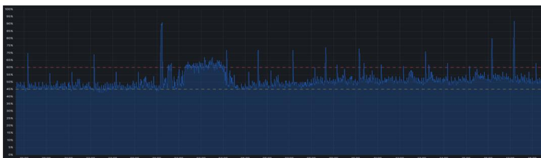
Рис. 3 - График нагрузки на процессора маршрутизатора Cisco за сутки
