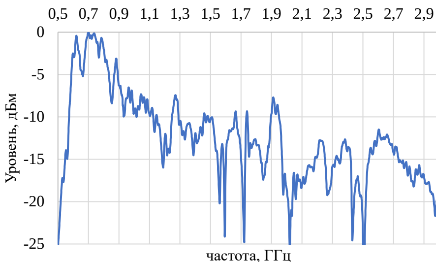
Рис. 4 – Измеренная АЧХ антенны
