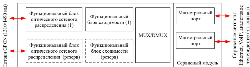
Рисунок 7 – Функциональная блок-схема ONU сети XGPON
