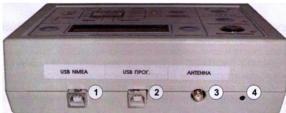
Рисунок 5.2 - Внешний вид задней стенки стенда
