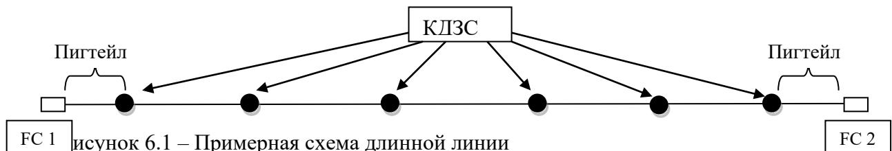
Для измерения параметров излучения на входе линии подключить источник излучения к FC1, а приемник к FC2. Для измерения параметров излучения на выходе линии отрезать от линии «пигтайлы» и сварить их между собой. За счет короткой длины фактически будет измеряться мощность или уровень оптического излучения на входе линии. Рассчитать потери, вносимые линией в оптический сигнал для двух длин волн.
