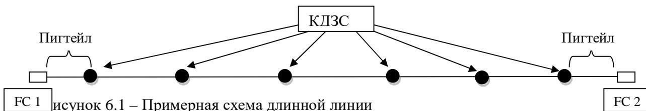
Для измерения параметров излучения на входе линии подключить источник излучения к FC1, а приемник к FC2. Для измерения параметров излучения на входе линии отрезать от линии «пигтейлы» и сварить их между собой. За счет короткой длины фактически будет измеряться мощность или уровень оптического излучения на входе линии. Рассчитать потери, вносимые линией в оптический сигнал для двух длин волн.
