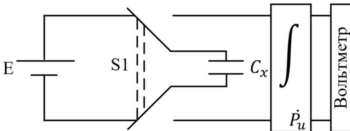
Рисунок 1 – Схема электрической цепи для определения емкости конденсатора
