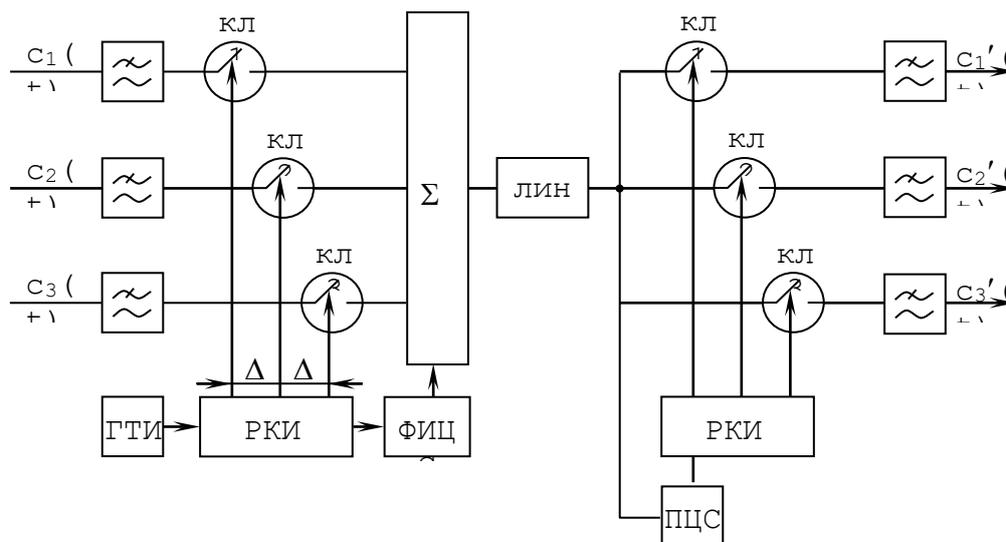
В передающей части системы индивидуальные непрерывные сигналы через ФНЧ, ограничивающие их спектр частотой  $F_b$ , поступают на электронные ключи, осуществляющие дискретизацию непрерывных сигналов.
