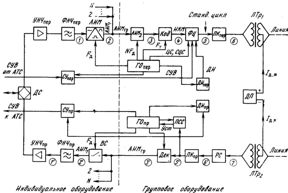
В состав оконечной станции аппаратуры ЦСП, предназначенной для передачи телефонных сигналов, входит индивидуальное и групповое оборудование. Узлы индивидуального оборудования всех  $N$  каналов однотипны, и на рисунке показано индивидуальное оборудование только для одного канала.
