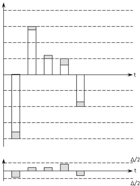
Расстояние между двумя соседними разрешенными уровнями называется шагом квантования ( $\Delta$ ). Из рисунка видно, что шаг квантования при равномерном квантовании постоянный.
