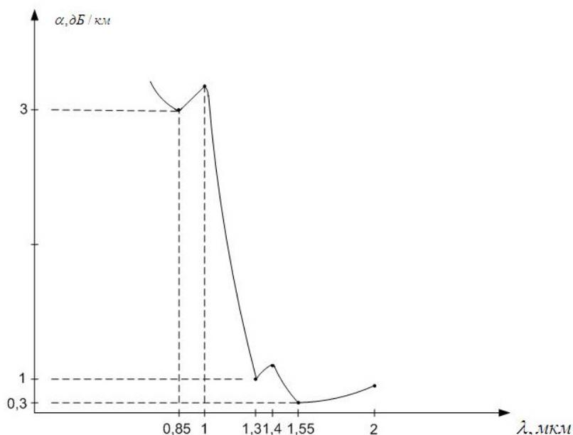
Всплески на характеристике на длинах волн 1,0; 1,4; 2 мкм обусловлены резонансами механических колебаний, атомов примесей и кварца сердцевины. «Провалы» на характеристике затухания, называется «окнами прозрачности». Длины волн 0,85; 1,3; 1,55 мкм соответствуют «окнам прозрачности» используются в качестве длин волн в ВОСП.
