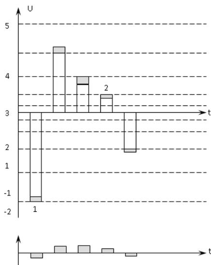
При неравномерном квантовании импульсы с маленькой амплитудой искажаются в меньшей степени, чем при равномерном т.к. меняется шаг квантования. За счет применения неравномерного квантования шум квантования ровный во всем динамическом диапазоне.
