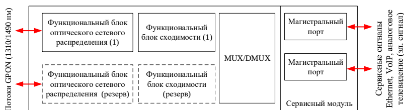
Рисунок 7 – Функциональная блок-схема ONU сети XGPON
