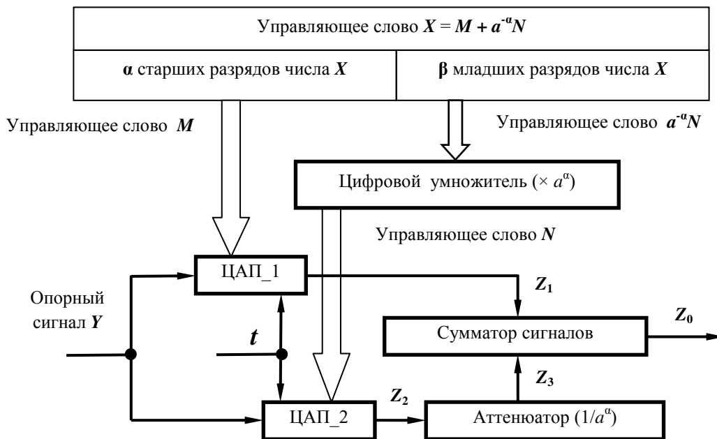
Рис.1. Многоразрядный параллельный ЦАП с аналоговым вложением ступенек младших разрядов
