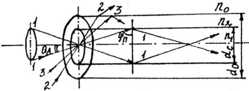
Рисунок 1 - Распространение луча в ОВ
