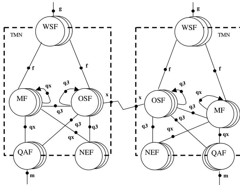
Рисунок 3 - Функциональная модель TMN
