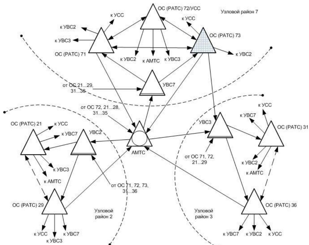
Рисунок 1 – Схема организации связи ГТС с односторонними транзитными узлами
