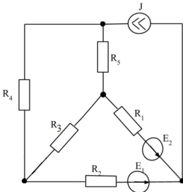
Рисунок 2 – Схема для расчета методом уравнений Кирхгофа
