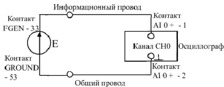
Рисунок 4 - Схема измерения параметров гармонического колебания
