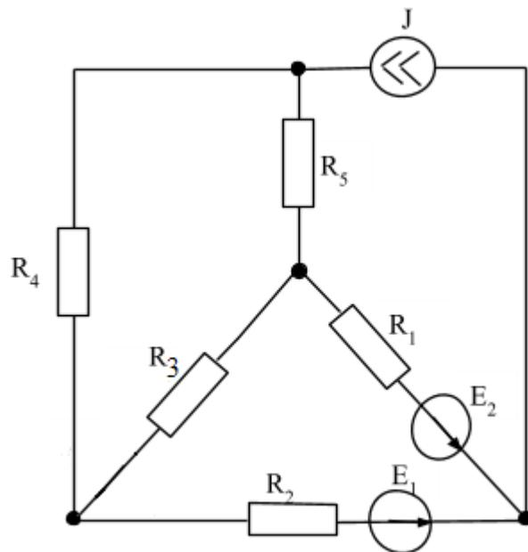
Рисунок 5 – Схема для расчета методом уравнений Кирхгофа
