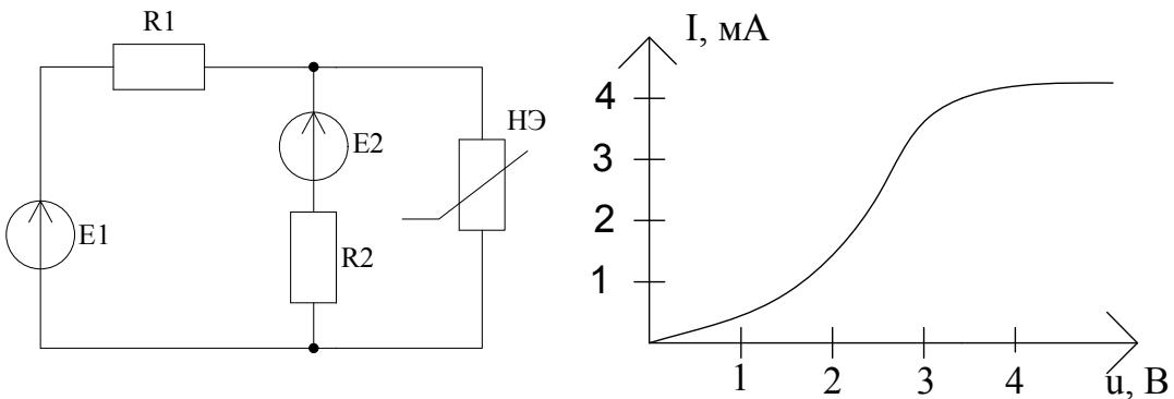
Рисунок 3 – Схема и ВАХ для расчета нелинейной цепи
