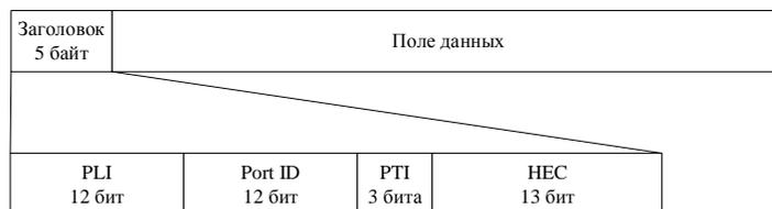
Рисунок 5 – Формат заголовка поля полезной нагрузки восходящего потока
