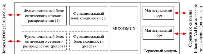
Рисунок 7 – Функциональная блок-схема ONU сети XGPON
