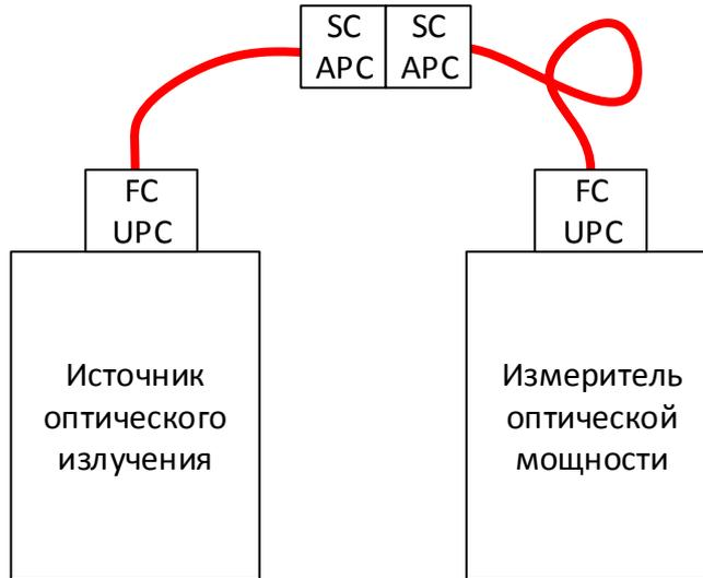
Рисунок 1 – Схема измерения опорной мощности ( $P_{оп}$ )
