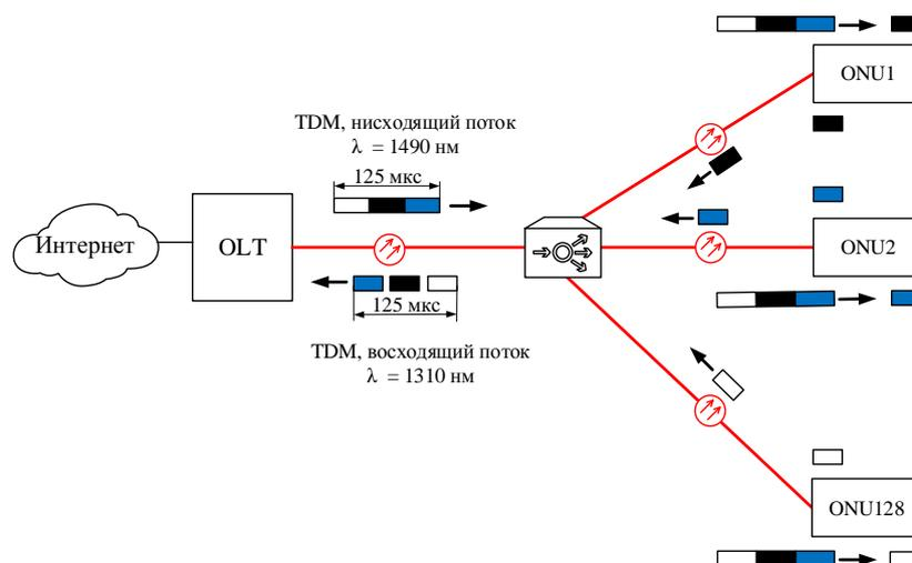
Рисунок 1 – Принцип передачи данных в сети GPON
