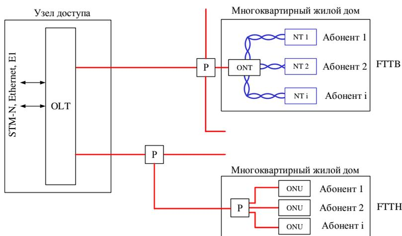
Рисунок 8 – Архитектура FTTB и FTTH сети GPON
