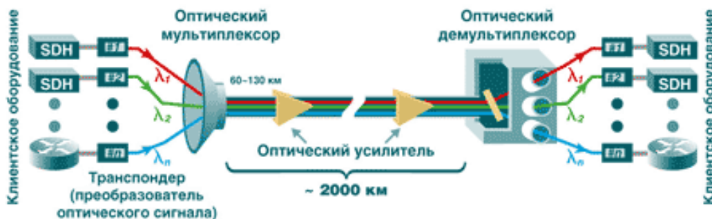
Рисунок 3 – Система передачи WDM
