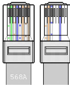
Рисунок А.4 – Положение проводников для ввода в разъем RJ-45
