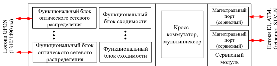
Рисунок 6 – Функциональная блок-схема OLT сети XGPON
