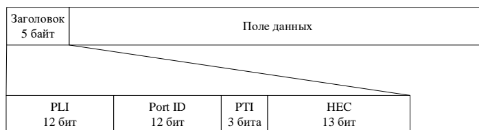
Рисунок 5 – Формат заголовка поля полезной нагрузки восходящего потока
