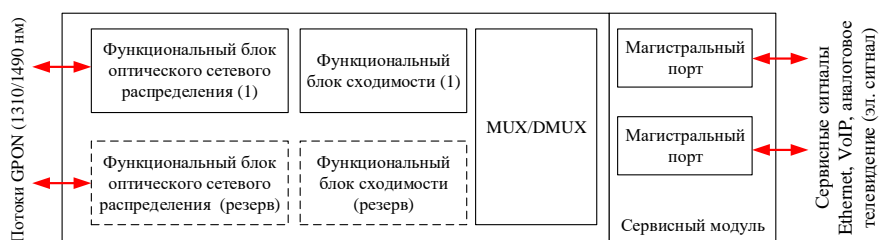
Рисунок 7 – Функциональная блок-схема ONU сети XGPON
