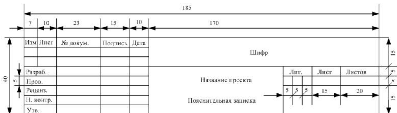
Рисунок Б.1 - Штамп листа содержания текстового документа
