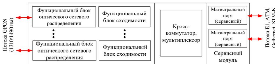
Рисунок 6 – Функциональная блок-схема OLT сети XGPON
