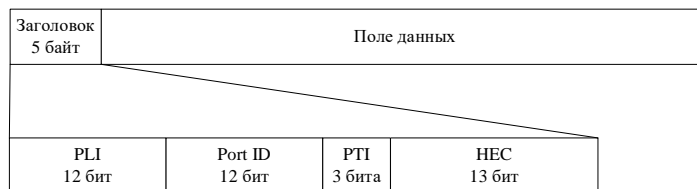
Рисунок 5 – Формат заголовка поля полезной нагрузки восходящего потока
