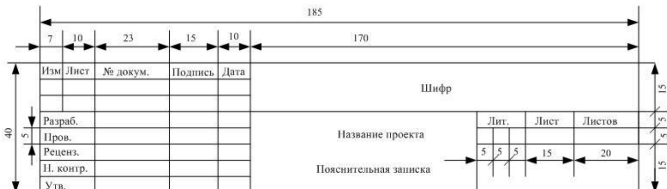
Рисунок Ж.1 – Штамп листа содержания текстового документа
